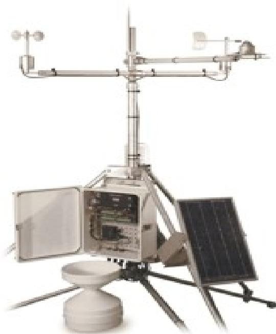
*Figura 10-Estação meteorológica automática Campbell como as instaladas nos piers da Base de Cananéia e de Ubatuba. Mede as variáveis vento, pressão, temperatura, umidade do ar etc. A distribuição de dados em tempo quase real é feita pela Internet através do Laboratório de Dados /DOF/IOUSP.*
