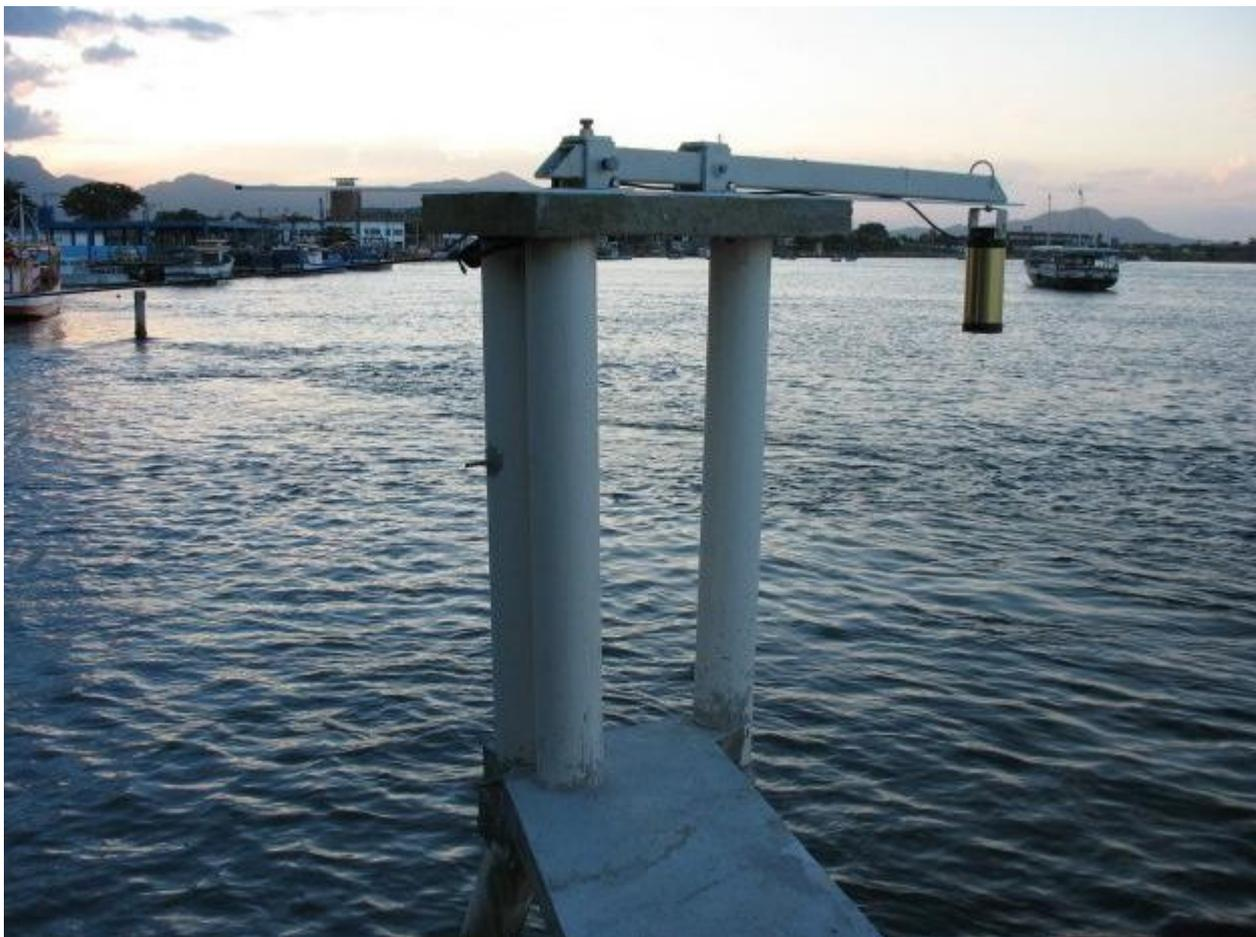
*Figura 7-Medidor de nível do mar KALESTO, de fabricação Alemã OTT, em operação na Base de Pesquisas de Cananéia (SP). Mede o nível do mar através de sinais de radar. Precisão da ordem de 2mm.*
